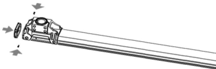
Fig. 51: Montar a tampa de fechamento
