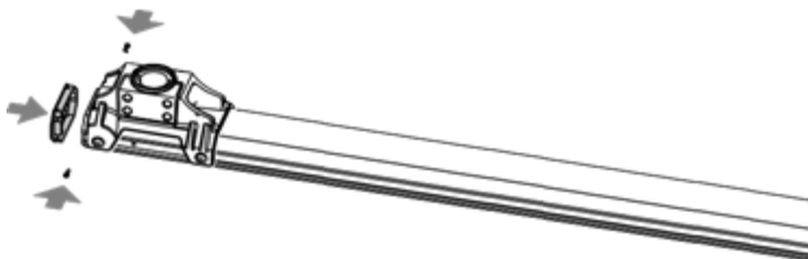
Fig. 26: Montar a tampa de fechamento
