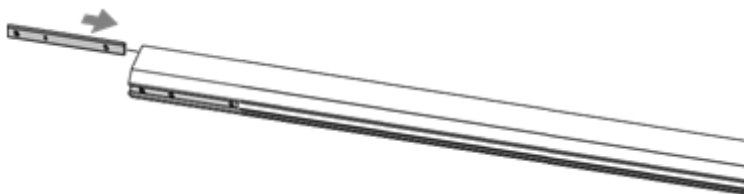
Fig. 49: Montar a porca ranhurada superior
