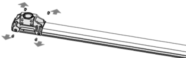
Fig. 46: Desmontar o flange
