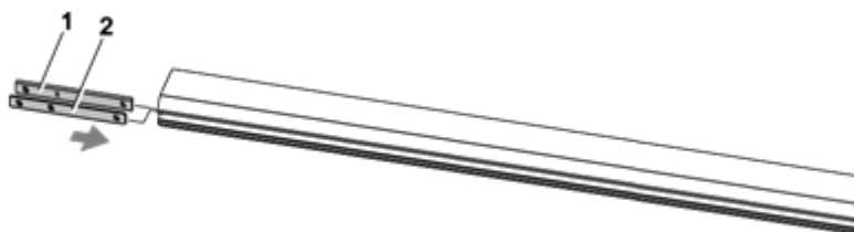
Fig. 48: Montar a porca ranhurada e a chapa adicional
