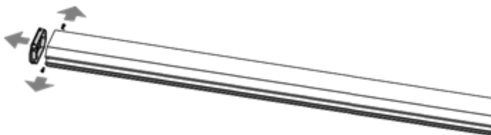
Fig. 47: Desmontar a tampa de fechamento
