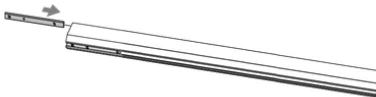
Fig. 24: Montar a porca ranhurada superior
