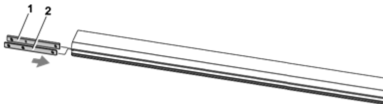
Fig. 23: Montar a porca ranhurada e a chapa adicional
