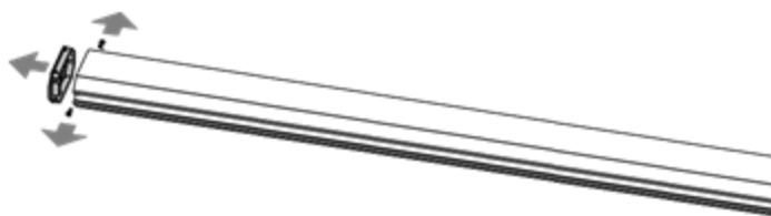
Fig. 22: Desmontar a tampa de fechamento
