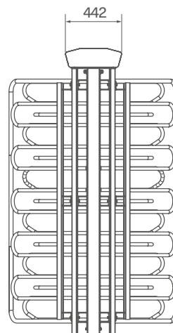
\*Embora a altura do equipamento seja de 2250mm, a altura mínima necessária para instalação é de 2400mm.
