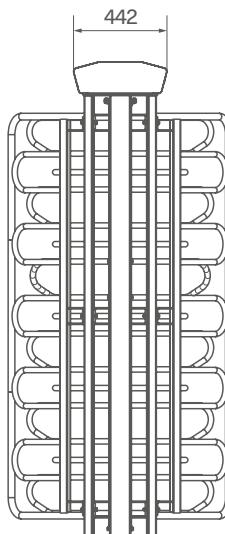
\*Embora a altura do equipamento seja de 2250mm, a altura mínima necessária para instalação é de 2400mm.
