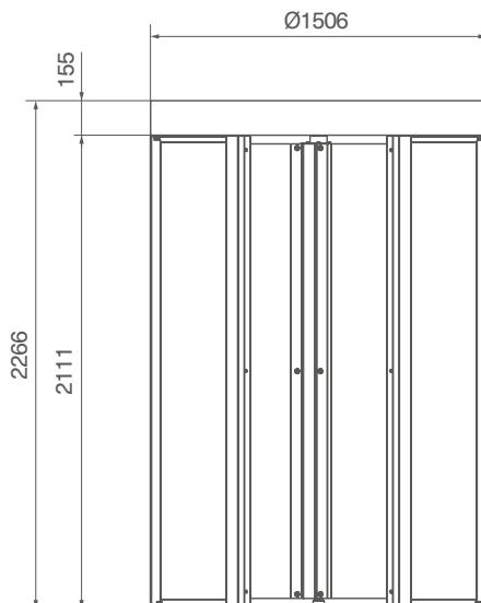
\*Embora a altura do equipamento seja de 2266mm, a altura mínima necessária para instalação é de 2600mm.
